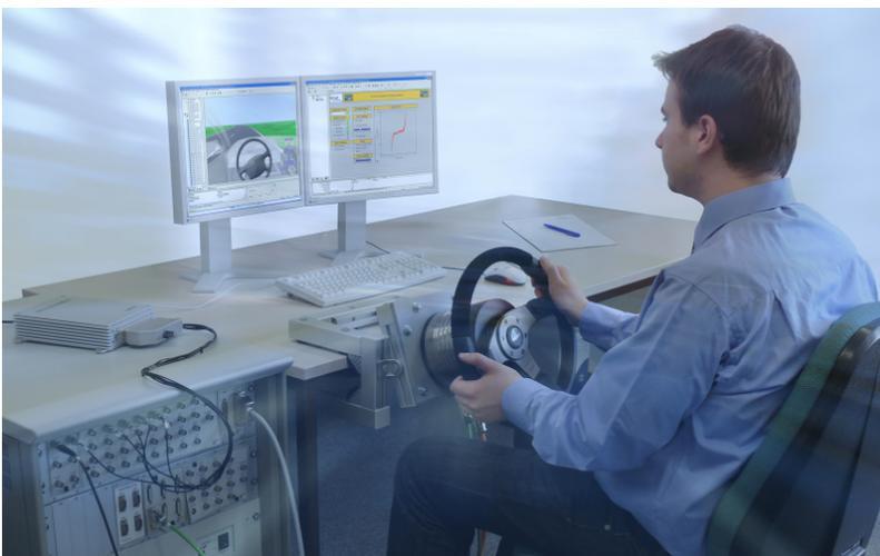
**Bild 1.1** HiL-Prüfstand mit Torque-Feedback-Lenkrad
